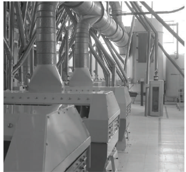
Zona de purificadores del molino de trigo
